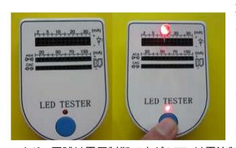
LED のチェックができます。写真のように、上部に穴が開いていて、ここに LED を差し込み、青いボタンを押すと LED が光ります。穴の上に書いてあるのは電流で、2 mAよりも 20 mA で LED を点けると明るく点灯するのがわかります。
